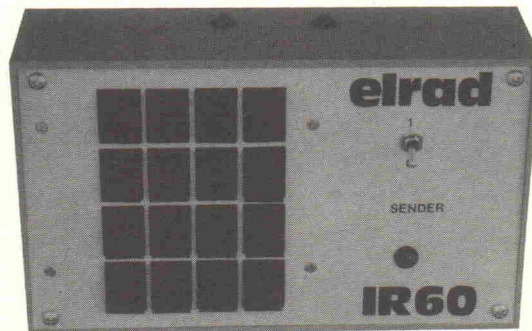
Der Steuersender, eingebaut in ein Pultgehäuse
