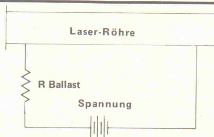
1b. Basisschaltung für eine Laser-Röhre. Der Ballast-Widerstand wirkt der negativen Widerstands-Kennlinie der Röhre entgegen.
